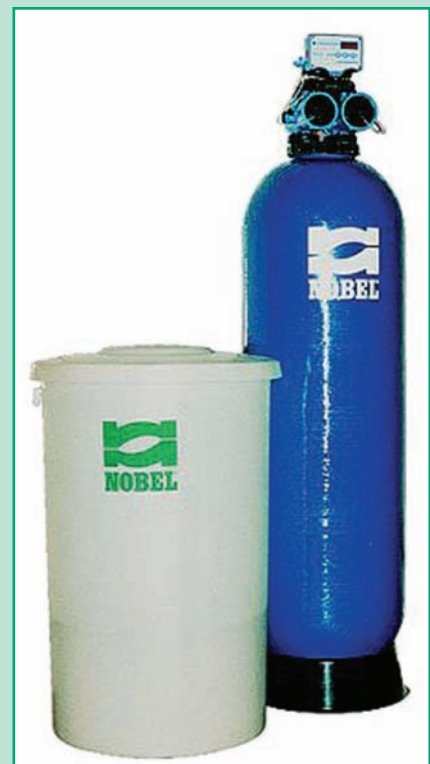
Stație de dedurizare AS 1345/T , cu comanda regenerării în funcție de timp, debit 5 m 3 /h, capacitate ciclică 1345 m 3 x °Fr, pentru instalații de încălzire de puteri mari.
